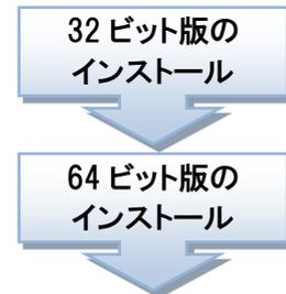
.vrp ファイルは、後からインストールしたCOMOS Walkinsideのバージョンにリンクします。上記のようにステップ1、ステップ2の順でインストールした場合、.vrp ファイルをダブルクリックすると 64ビット版の COMOS Walkinside が起動します。
